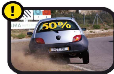
Versleten schokdempers verminderen de stabiliteit in de bochten en veroorzaken zijwindgevoeligheid.
