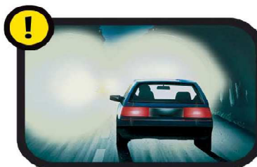
Versleten schokdempers veroorzaken het deinen van de koplampen wat tegenliggers kan verblinden.
