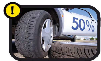
Een versleten schokdemper verhoogt de bandenslijtage met meer dan 7% waardoor het wegcontact vermindert.
