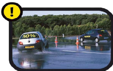
Op een nat wegdek verhogen versleten schokdempers de kans op aquaplaning met 15% en verlengen de remafstand met 6 meter.
